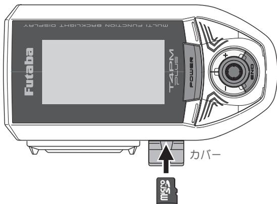
5. 送信機の END ボタンを押しながら電源を ON します。アップデートが開始されます。
