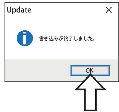
以上でアップデート作業が終了となります。「OK」を押して電源を OFF し、製品からケーブルを取り外して下さい。
