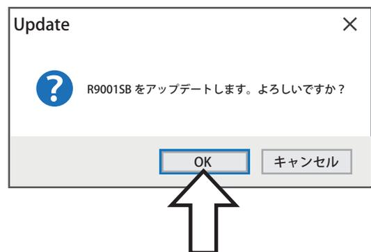
12. アップデートが開始されます。アップデート中は、PCソフトのUpdateのバーグラフが進行し、R9001SBの緑LED点灯中に、赤LEDがチラチラと点滅します。
