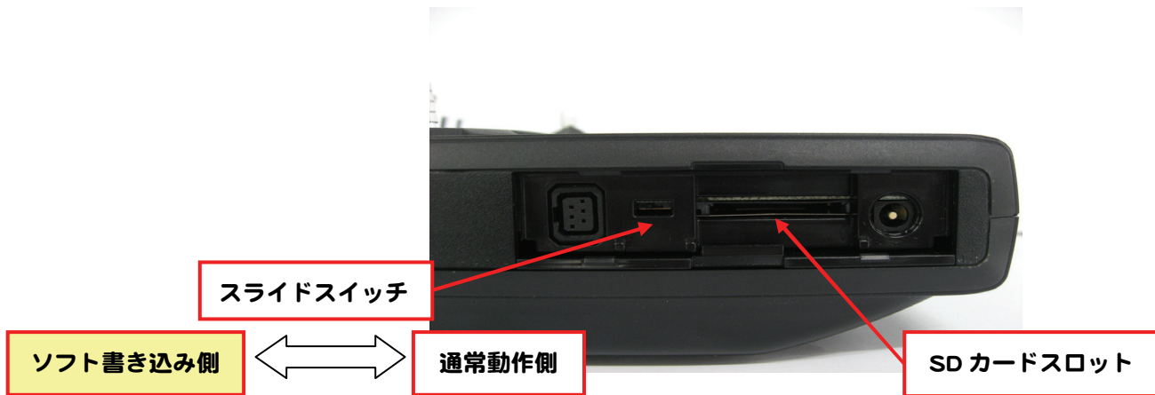
(FX-20 側面カバー内部)
