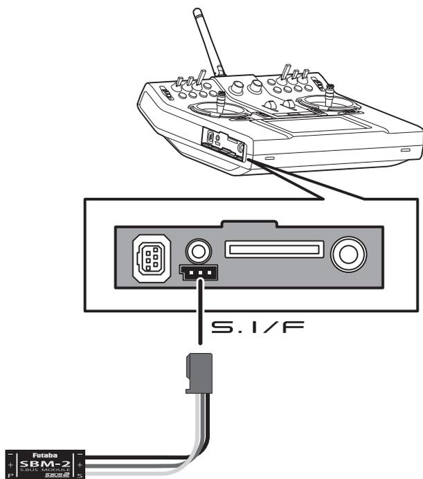
送信機裏面の S.I/F コネクターに SBM-2 を接続します。
