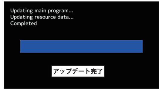
7. アップデートが正常に完了したメッセージが出てから、電源スイッチを押し、電源を OFF にしてください。
