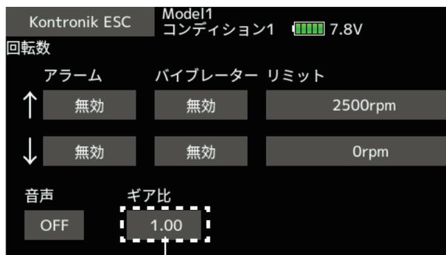
ギヤダウンしている場合はギヤ比を入力するとヘリのローター回転数、飛行機のギヤダウンしたプロペラ回転数が表示されます。
