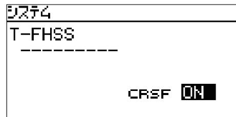
2.4 GHz の電波の発射が停止され、S.BUS 設定コネクタ (S.I/F) から CRSF 規格に準拠した信号が出力されます。
