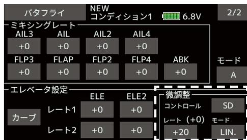
※主翼タイプが無尾翼のとき、エレベーター設定の微調整機能は表示されない。(無尾翼の場合、エレベーターのレート設定が無いため)
