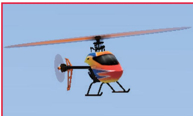
【制御チャンネル】 5チャンネル：エルロン／エレベーター／スロットル／ラダー／コレクティブピッチ
