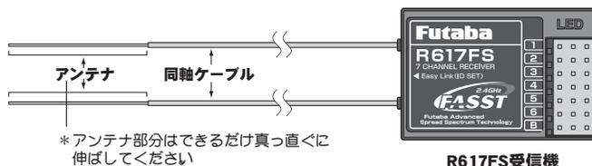
2つの異なる位置で信号を受信できるように、2つのアンテナが装備されています。(ダイバーシティ方式アンテナ) 2つのアンテナの受信状態の良い方に自動的に切り替えて常に安定した受信状態を確保しています。R617FSの性能を発揮させるために、次の手順および注意事項に従って搭載してください。
