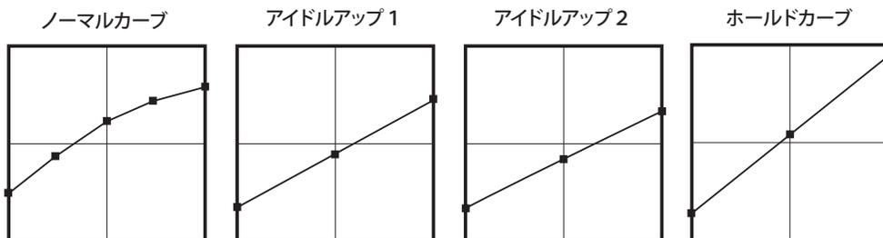
上のカーブ画面は、各コンディション毎に 0% (ロー側)、25%、50% (センター)、75%、100% (ハイ側) の 5 ポイントまたは 3 ポイントのデータを調整して作成したカーブです。
