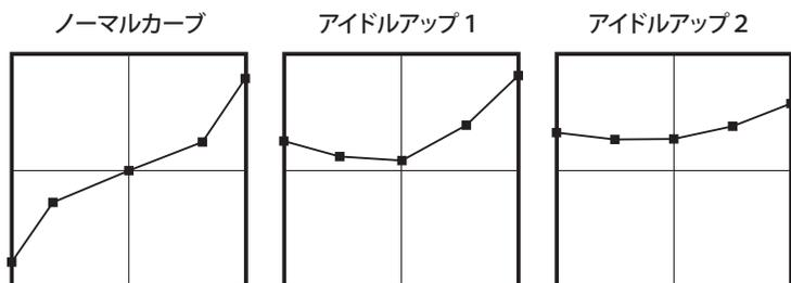
上のカーブ画面は、各コンディション毎に0%（ロー側）、25%、50%（センター）、75%、100%（ハイ側）の5ポイントのデータを入力して作成したカーブです。
