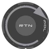
タッチセンサ操作前に、タッチセンサ周辺に指が触れている場合、指を一度離してからタッチ操作を行ってください。タッチセンサ周辺を触っているとセンサが誤反応してスムーズに動作しない場合があります。
