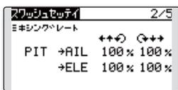
スロットルスティックを、最スロー、フルハイと動かしたとき、スワッシュプレートが水平に動くように、PIT → AIL、PIT → ELE 量を調整します。
