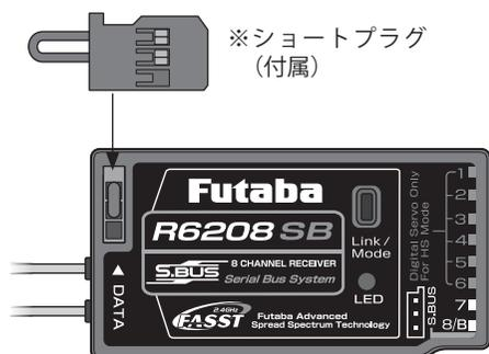
※S.BUS サーボのチャンネル設定時のみ DATA ポートにショートプラグを接続してください。通常使用時はプラグを接続しないでください。
