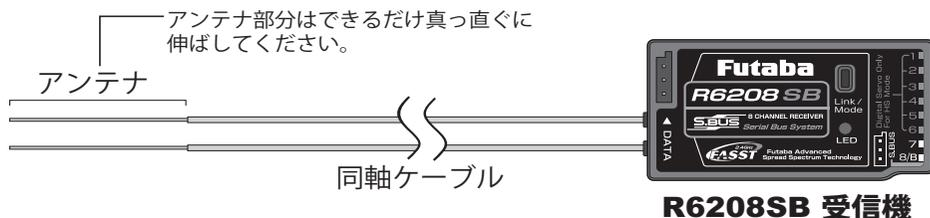
2つの異なる位置で信号を受信できるように、2つのアンテナが装備されています。(ダイバーシティ方式アンテナ) 2つのアンテナの受信状態の良い方に自動的に切り替えて常に安定した受信状態を確保しています。受信機の性能を発揮させるために、次の手順および注意事項に従って搭載してください。
