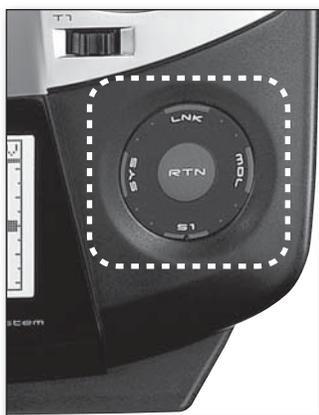
タッチセンサがスムーズに動作しない場合は無理に強く押さず、指を 2cm 以上離してから再度操作してください。
