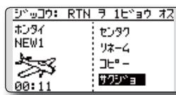
4. RTNボタンにタッチ（1秒）すると、モデルが削除されます。（中止する場合はタッチセンサーをスクロール操作するか、S1ボタンにタッチします。）
