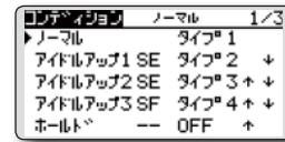
コンディション切り替えスイッチ、コンディションの優先順位が変更可能です。コンディションを設定し終わったらスイッチを操作してみて、画面上に表示されるコンディション名で確認してください。
