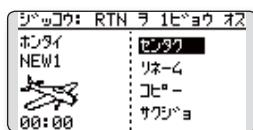
4. 再度RTNボタンにタッチ（1秒間）すると、呼出しが完了します。（中止する場合はタッチセンサーをスクロール操作するか、S1ボタンにタッチします。）
