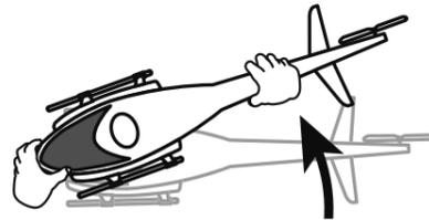
地上でジャイロが動作状態でヘリを左回りに回して、テールローターのピッチが強くなるかチェック (メインローターが右回転の場合)
