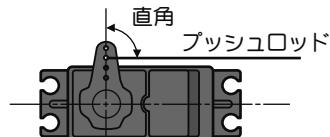
※サーボホーンに、機体側に付属のボルトを取り付けてください。（機体メーカーの指示を基準に搭載します。）
