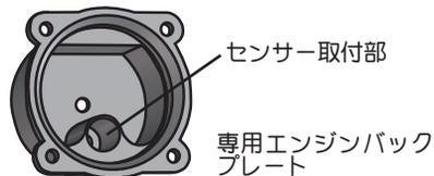
2 エンジンバックプレートのセンサー取付部に底面から約 1/3 (約 0.3CC) シリコン系接着剤を注入する。
