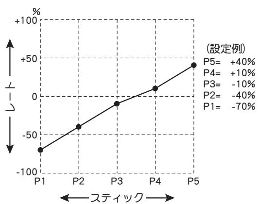
アイドルアップ 1 のピッチカーブは、ポイント 1、2 をノーマルと同じ設定値とし、ホバリングよりハイ側は、エンジン (モーター) パワーにより異なりますが、およそ最大ピッチ角が 8～10° の間になると思われます。
