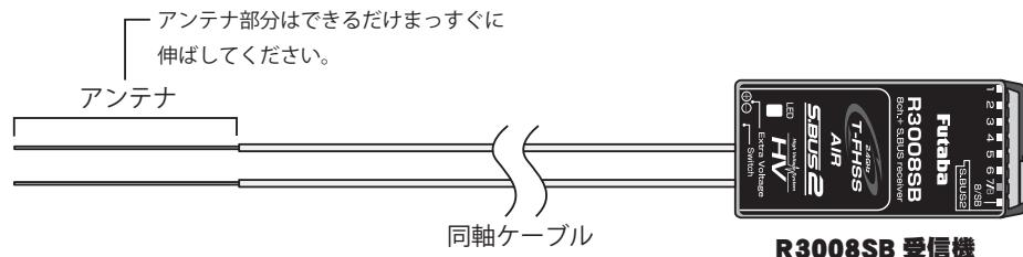
R3008SB はダイバーシティーアンテナが装備されています。2本のアンテナを自動的に切替えて常に安定した受信状態を確保しています。受信機の性能を発揮させるために、次の手順および注意事項に従って搭載してください。
