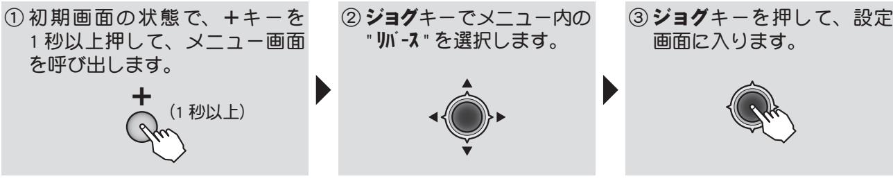
誤設定防止のため、上記でサーボリバース画面を呼び出した後、ジョグキーを左右に押さなければチャンネルは選択されていません。
