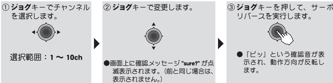
安全のため、ダブルセット方式を採用しています。確認メッセージ表示後、変更を取りやめるときは、ジョグキーで別の設定項目に移動するとサーボリバースは実行されません。
