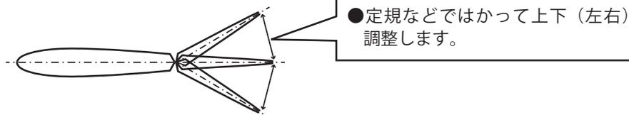
●プロポを最大操作したときに、各舵が動作する範囲をこえてサーボが動作しようとするとうサーボがうなりまします。負荷がかかりすぎるようだと、サーボが故障するので、リンケージやプロポの舵角調整（エンドポイント、ATV、EPA）でサーボの動作量を少なく調整してください。
