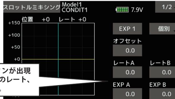
タッチすると数値入力ボタンが出現します。ミキシングの全体のレート、EXP レートを調整できます。
