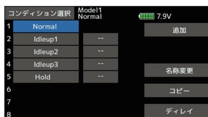
コンディション切り替えスイッチ、コンディションの優先順位、コンディションの名前等を設定してください。コンディションを設定し終わったらスイッチを操作してみて、画面上に表示されるコンディション名で確認してください。
