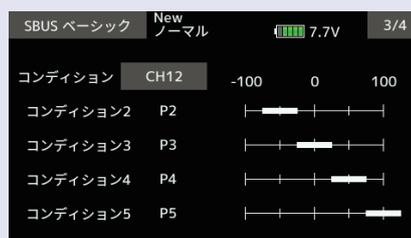
\* 送信機のフライト・コンディション機能のように、送信機からのスイッチ操作で、いくつかのパラメータを最大 5 通りのデータを設定して切替えて使用することができます。送信機の AFR 機能のあるチャンネルにコンディション・スイッチを設定し、AFR のポイントカーブでフライト・コンディション毎にポイントを設定すると、フライト・コンディション・スイッチと連動させることも可能です。
