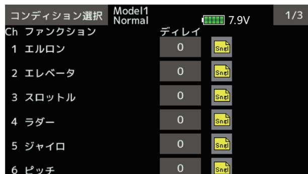
3. 設定したいチャンネルの " ディレイ " の項目をタッチして数値入力ボタンを表示します。タッチしてディレイ量を調整します。
