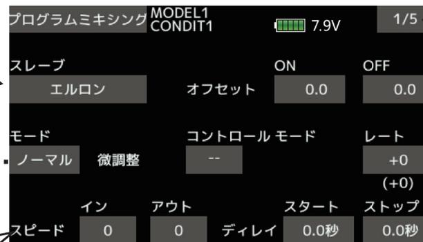
●微調整の設定 ボリュームなどでオフセット量を微調整操作したい場合に使用します。設定方法については巻末の説明
