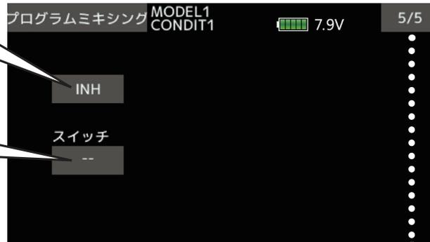
●設定画面の呼出機能を有効にしたいミキシング No. をタッチして設定画面を呼び出します。右上のページをタッチして 5/5 ページにします。
