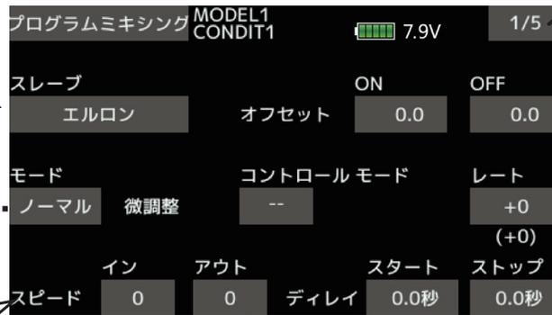
●微調整の設定 ボリュームなどでオフセット量を微調整操作したい場合に使用します。設定方法については巻末の説明「[微調整ボリュームに関する操作](#)」を参照してください。
