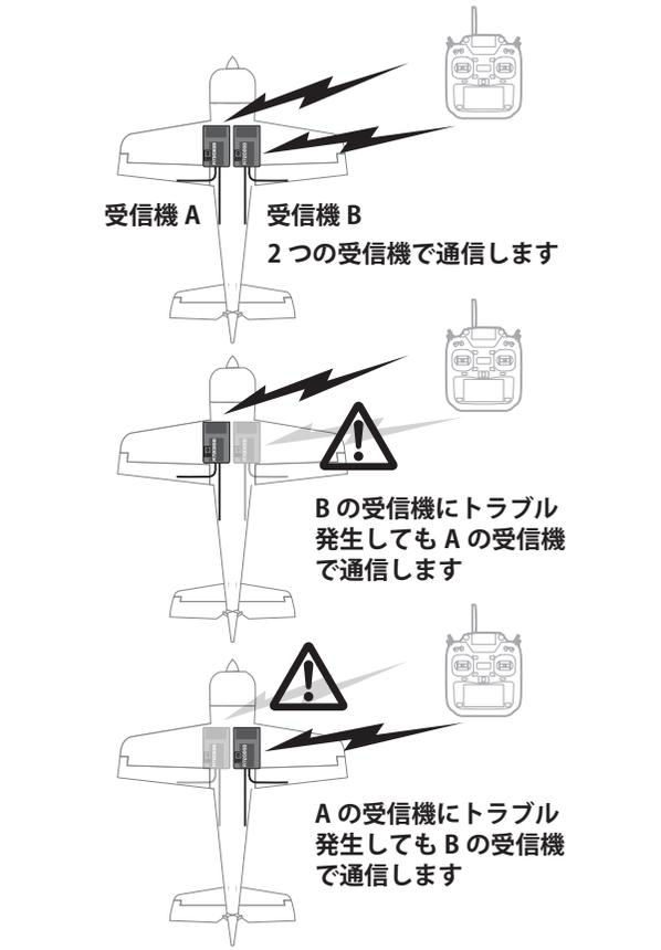
デュアル RX リンクモードでは SB2/RX ポートは受信専用となるため、S.BUS出力、S.BUS2 入出力する場合は CH モードの B, C, D, F, G モードを使用して下さい。
