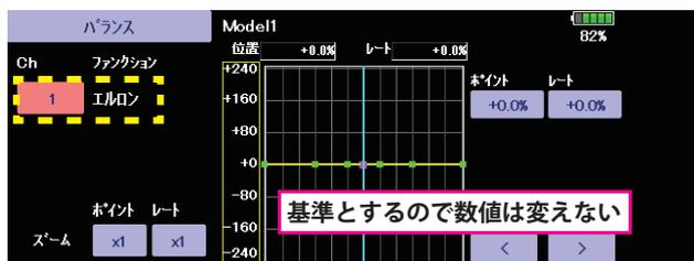
CH11の補正カーブを設定する。サーボ12のリンクージは外しておきます。
