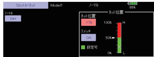
ただし、安全のため、スロットル・スティックがスロー側 25% より下側のときのみ、エンジン・カット機能が働きます。
