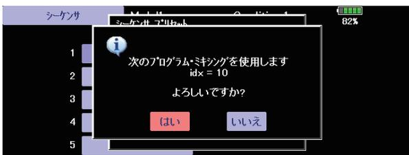
●シーケンサは設定すると自動的にプログラムミキシングを使用します。使用していないプログラムミキシングの後方の番号 (idx=xx) を利用します。この確認画面がでますので「はい」をタップすると設定可能になります。
