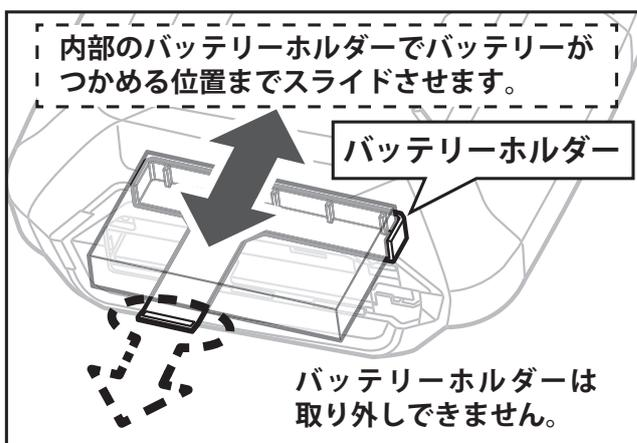
3. バッテリーホルダーからバッテリーを外して取り出します。
