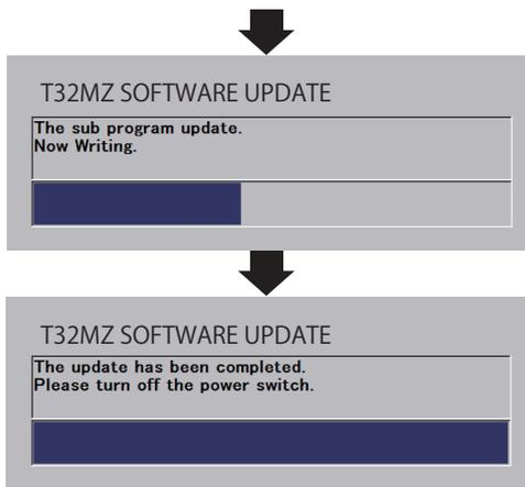
10. アップデートが正常に完了したメッセージが出てから、電源スイッチを押し、電源を OFF にしてください。
