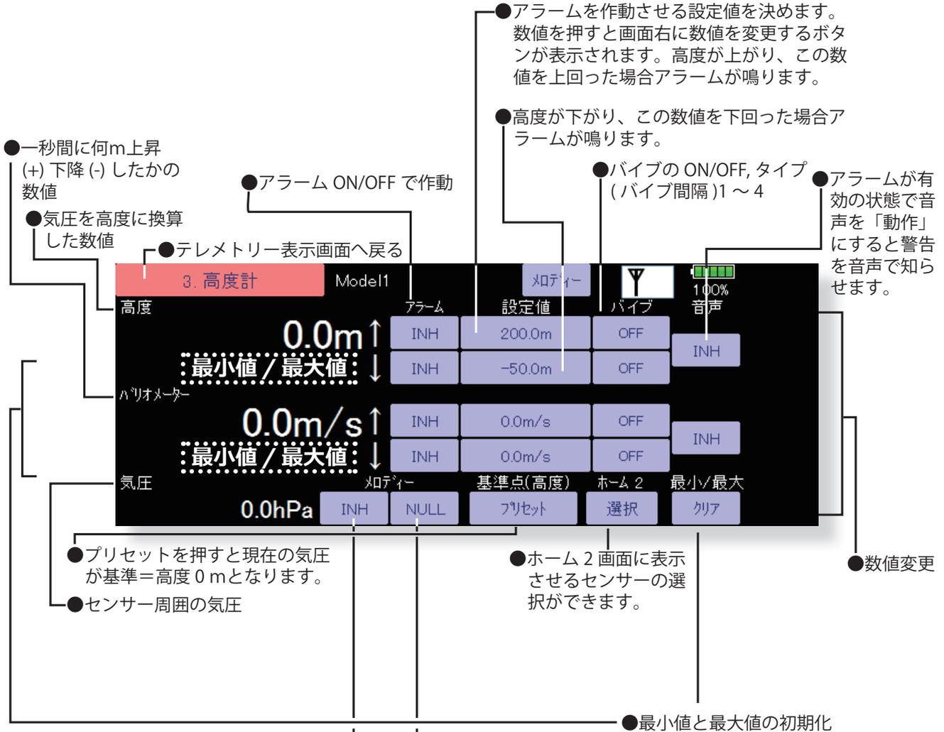
●高度計を使用した時に、バリオメーターのデータによってメロディー音が鳴ります。上昇、下降で、異なるメロディー音が鳴ります。上昇率/下降率によって、メロディー音の間隔が変わります。メロディー機能と音声読み上げ機能は、同時に使用することができます。
