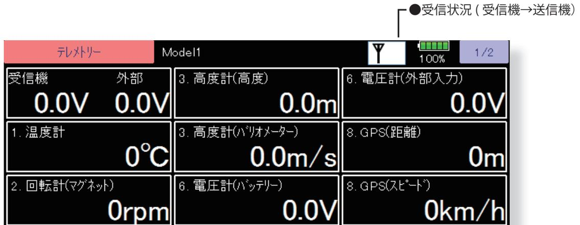
● それぞれの項目を押すと、アラームとパイプの ON/OFF、音声の動作設定などの詳細設定画面に移動します。
