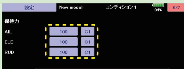
送信機のチャンネル操作で、現在のナンバー C1 ~ C5 を表示し、調整することもできます。
