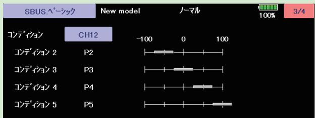
\* 送信機のフライト・コンディション機能のように、送信機からのスイッチ操作で、いくつかのパラメータを最大 5 通りのデータを設定して切替えて使用することができます。送信機の AFR 機能のあるチャンネルにコンディション・スイッチを設定し、AFR のポイントカーブでフライト・コンディション毎にポイントを設定すると、フライト・コンディション・スイッチと連動させることも可能です。
