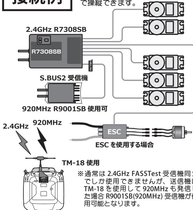
※通常は 2.4GHz FASSTest 受信機同士でしか使用できませんが、送信機に TM-18 を使用して 920MHz も発信した場合 R9001SB(920MHz) 受信機が使用可能となります。
