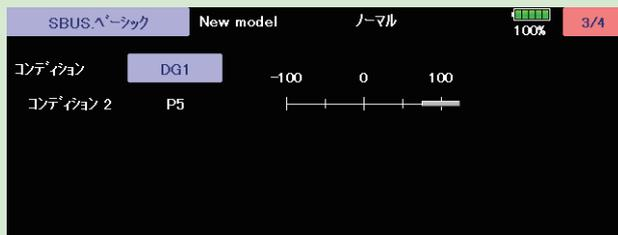
ジャイロのコンディション切り替えスイッチチャンネルを設定します。
