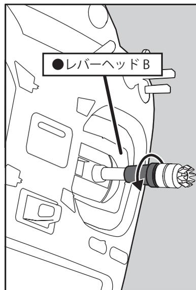
3. レバーヘッド A をおさえてレバーヘッド B を反時計まわりに回し、しっかりロックします。
