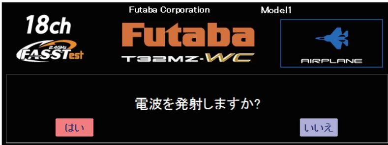
1. [U.MENU/MON.] を押しながら、※左の確認画面が出るまで [U.MENU/MON.] を押し続けます。そのまま電源を ON します。確認画面で「電波を発射しますか?」と表示されたら [いいえ] を押します。
