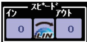
各ファンクション操作時（フライトコンディションの切替時を含む）の動作スピードを調整できます。設定したスピード量に対応した一定のスピードでなめらかに動作します。操作時（イン側）とリターン時（アウト側）のスピードを個別に設定できます。
