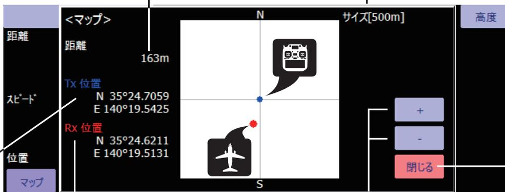
● マップのサイズを表します。Tx 位置 (マップ中央の基準点) から端までの距離となります。サイズは+/-ボタンで変更できます。
