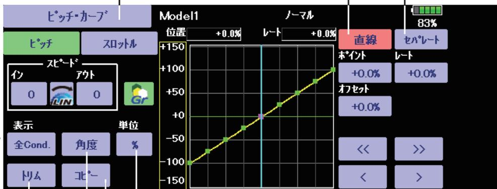
●トリムは、ホバリング・ピッチやピッチ・トリムとして使用できます。ハイ、ロー側ピッチの微調整もできます。
