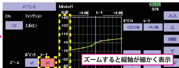
バランスでレート設定されたCHはカーソルが黄色に表示されます。
