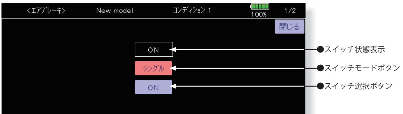
\*スイッチモードボタンを押すと、シングルスイッチモードとロジックスイッチモードが切り替わります。シングルスイッチモードは従来と同じ単独のスイッチで使用するモードです。
