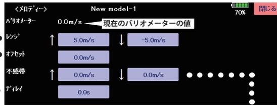
※これらの設定項目は、各センサー毎に設定します。センサー毎のバリオメーターのアラーム設定画面で設定します。
