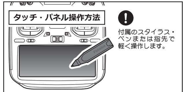
\*タッチ・パネルは、表面はプラスチック・フィルム、裏面は薄いガラスのサンドイッチ構造となっています。表面は鉛筆芯 2H 相当の硬度です。硬い金属などで表面を押すとキズとなり、修復不能となります。また、ガラスが使われているため、過度の力を加えると、ガラスが破損します。
