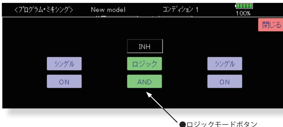
\*スイッチ選択ボタンがロジックモードボタンに変わり、左右にスイッチモードボタンとスイッチ選択ボタンが表示されます。左右に表示されたスイッチとロジックモードの組み合わせで、ON/OFF が決まります。
