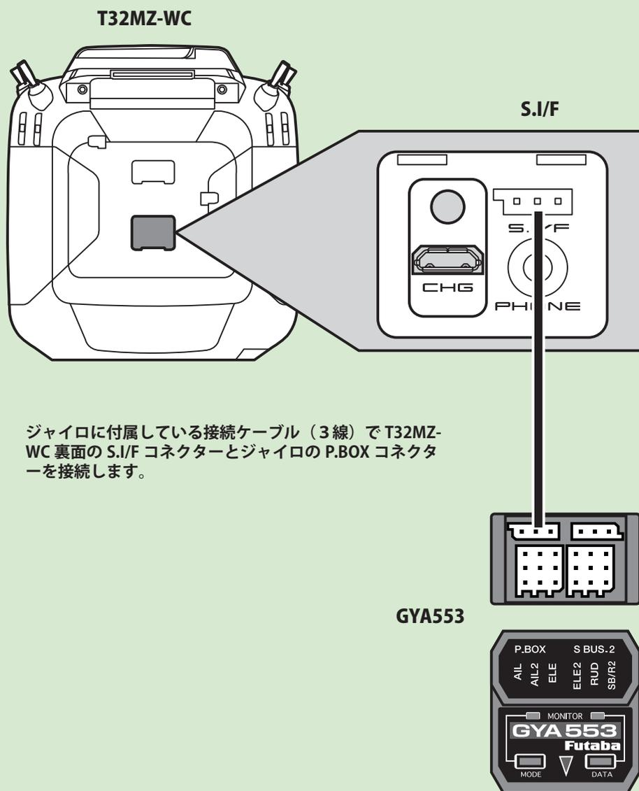
ジャイロに付属している接続ケーブル（3線）で T32MZ-WC 裏面の S.I/F コネクターとジャイロの P.BOX コネクターを接続します。
