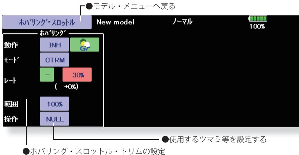
ホバリング・スロットルは、ホバリング・ポイント付近のスロットルのトリム機能です。通常はホバリングのコンディションで使用します。温度、湿度等飛行条件の変化に伴うローター回転数の変化に対し微調整ができます。ローター回転が一番安定するように調整して下さい。又ホバリング・ピッチ機能と併用することにより、より細かく微調整が可能になります。
