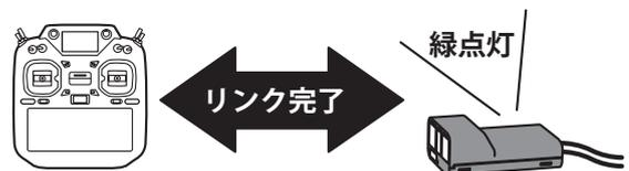
※送信機の新規モデル追加時、通信システムを変更した場合、通信できなくなります。再度リンク設定を行ってください。
