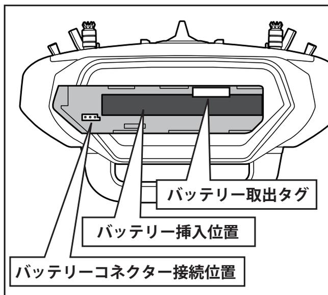
2. バッテリー取り出しタグをひっぱってバッテリーを少し出します。
