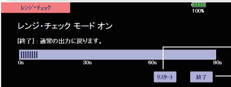
4. レンジチェックモードは 90 秒後に自動的に解除され、通常モードで電波が送信されます。解除されるまでの時間 (秒) が表示されます。
