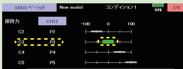
送信機のチャンネル操作で、現在のナンバー C1 ~ C5 のチャンネルポジションが緑表示になります。
