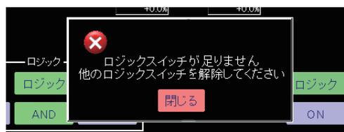
2. ON/OFFスイッチにロジックスイッチを使用したミキシングは、コンディションシングルモードに強制的に切り替えられます。ロジックスイッチを解除するまで、コンディショングループモードに切り替えることは出来ません。
