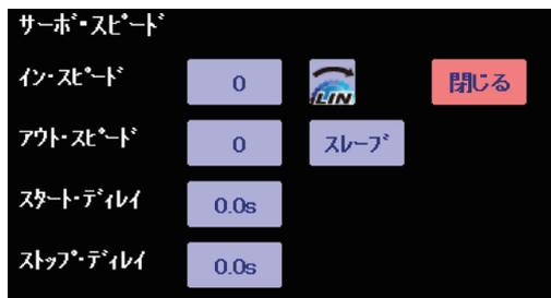
サーボ・スピードの設定 (その 1) の機能にさらに操作時（イン側）とリターン時（アウト側）の動作開始点の設定ができます。
