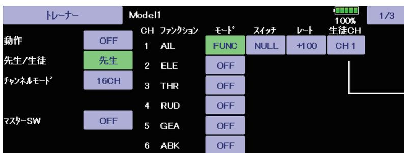
3. 設定するチャンネルのモードで [FUNC] [MIX][NORM] のいずれかを選択すると [生徒 CH] の設定ボタンが表示されます。
