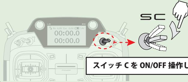
スイッチ C を ON/OFF 操作します。
