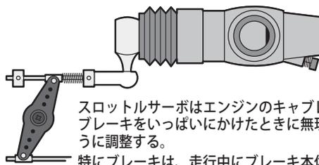
特にブレーキは、走行中にブレーキ本体が熱により効きが悪くなるため、ATLでブレーキ舵角を増やすケースがありますが、走行前に適正な最大舵角量をエンドポイントで調整し、走行中にATLで舵角を増やしてもサーボに無理な力が加わらないようにする。
