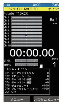
ホーム画面の状態ではゲイン調整を操作すると、画面上部にポップアップでジャイロゲインを表示します。
