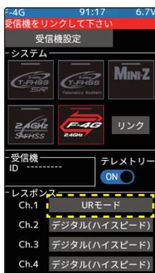
「受信機をリンクして下さい。」と表示されます。受信機をリンクしないと UR モードに変更されません。
