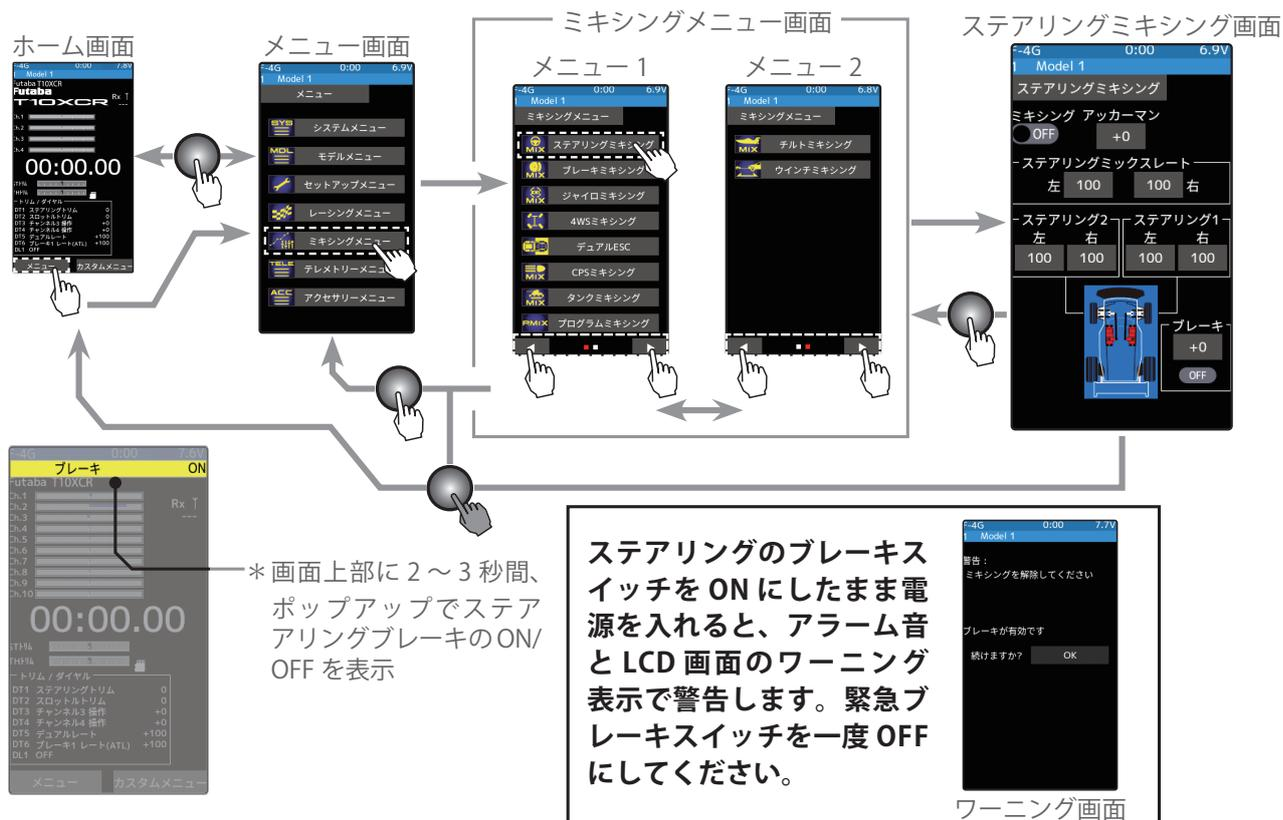
ミキシング機能は、Ch.3 / 4 またはその他の空きチャンネルに割り当てます。他のミキシングで使用しているチャンネルは使用できません。チャンネルが不足する場合は、他のミキシングを解除してください。ステアリング 1/2 両方のサーボをワイヤレス方式 (S.BUS/ サーボ機能) でパラメーター変更をしたい場合、ミキシング機能を Ch.2 に割り当て 1,2ch の両方をステアリングに設定します。スロットルはセットアップメニュー → **チャンネル設定機能** で Ch.3 また Ch.4 に変更します。
