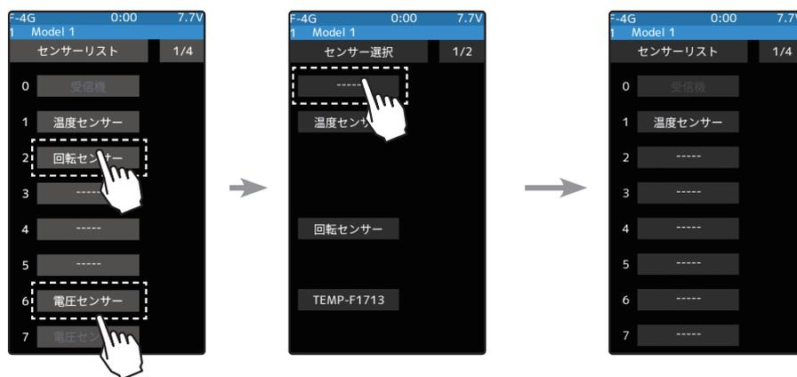
3 センサーリストのスロット1[温度センサー]を選択し、センサー選択画面の2ページ目に表示される【MC970CR】を選びます。テレメトリー画面のスロット1に【MC970CR】(MC971CRの場合はMC971CR)が表示されます。
