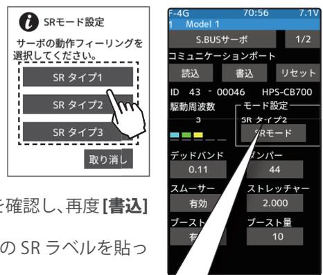
⊙ SRモードに設定したサーボは、すべての受信機のS.BUSチャンネルには、絶対接続しないでください。サーボが故障します。
