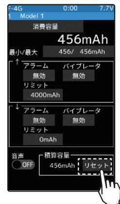
送信機側でのリセット操作は、T10XCRの積算容量表示をリセットする機能で、SBS-01C本体の積算値をリセットするものではありません。SBS-01Cの消費容量測定範囲は最大32767mAhです。これを超えた場合、送信機の消費容量表示も自動的にリセットされます。タイミングによっては計測中にリセットされてしまう場合がありますので、積算容量の表示が32767mAhになる前に、SBS-01C側の積算をリセットしてください。
