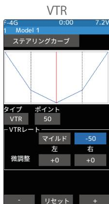
ニュートラルから最大舵角の間に、切り替わるポイントを設定し、2段階の直線的カーブで動作させるタイプ。サーボの最大舵角には影響しません。
