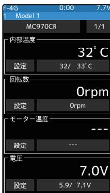
MC970CR がテレメトリーセンサーとして登録されると、他の温度センサーや回転センサー等と同じようにリミット、アラーム、バイブの設定が可能です。
