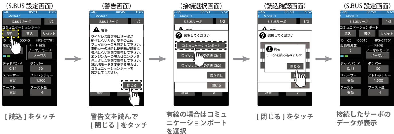
**4** UR モードへ変更して UR タイプを選択し、接続した UR サーボへデータを書込みます。
