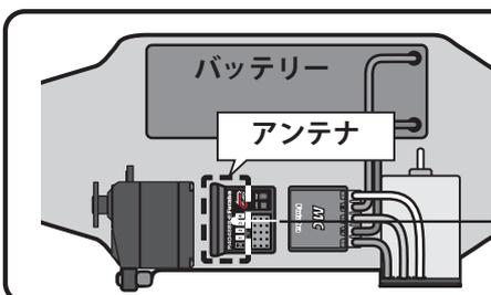
受信機はバッテリー、モーターコントローラー、モーターやシリコンコードなどのノイズ源から可能な限り離す。特にアンテナ線は絶対に近付けない。
