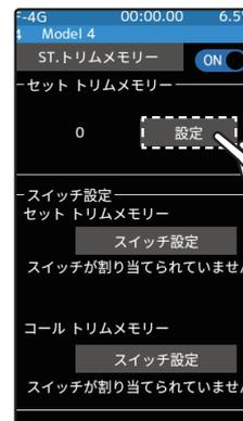
ステアリングのトリム調整後に右の画面の [ 設定 ] をタッチすると現在のトリム値がメモリーされます。
