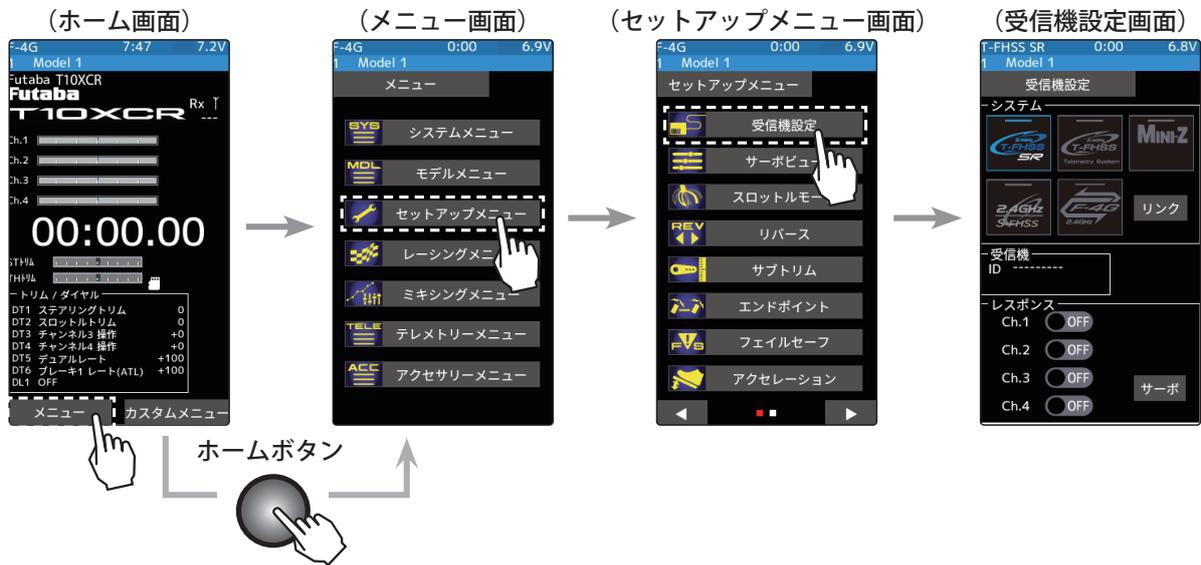
T-FHSS SR の場合、T-FHSS に比べレスポンスアップさせる「SRモード」が使用できます。受信機設定で SR モードの各チャンネルの(ON●)/(●OFF) をタッチして変更します。変更すると表示が変わります。動作確認前に必ず受信機の電源を入れなおします。SR モードは、チャンネル単位で ON/OFF の設定ができます。通常のサーボまたは ESC を使用する場合は、接続するチャンネルの SR モードを(●OFF) にしてください。
