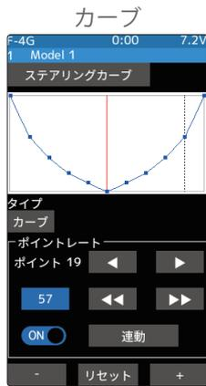
ニュートラルから最大舵角の間に、最大21段階ポイントを設定し多角カーブで動作させるタイプ。サーボの最大舵角には影響しません。
