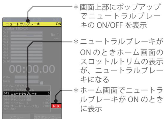
ニュートラルブレーキスイッチを ON にしたまま電源を入れると、アラーム音と LCD 画面のワーニング表示で警告します。ニュートラルブレーキスイッチを一度 OFF にしてください。
