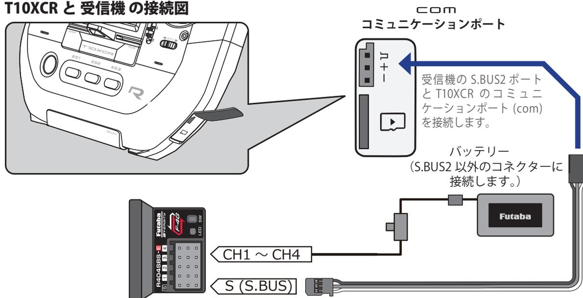
T10XCR の DSP または PWR スイッチを ON にして、受信機アップデート画面を、次の方法で表示します。
