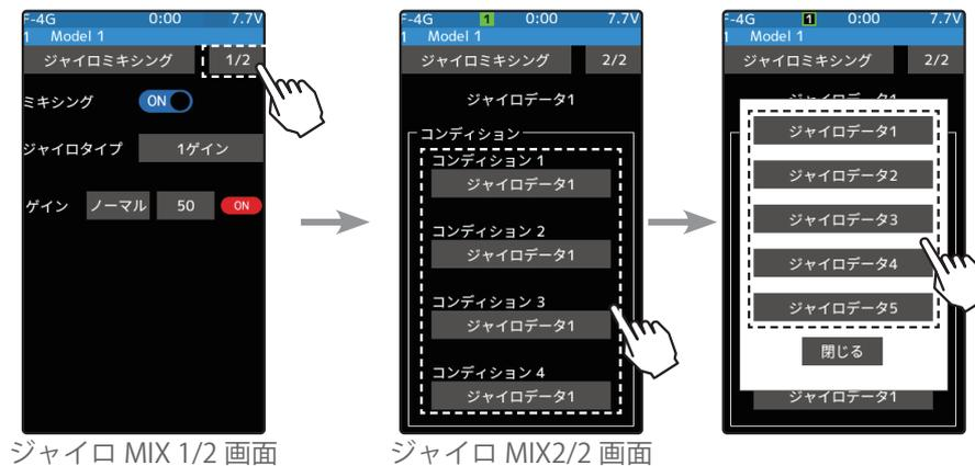
ホーム画面にジャイロの現在の動作モード (ノーマル / AVCS) と、選択されているジャイロデータインジケータを表示します。
