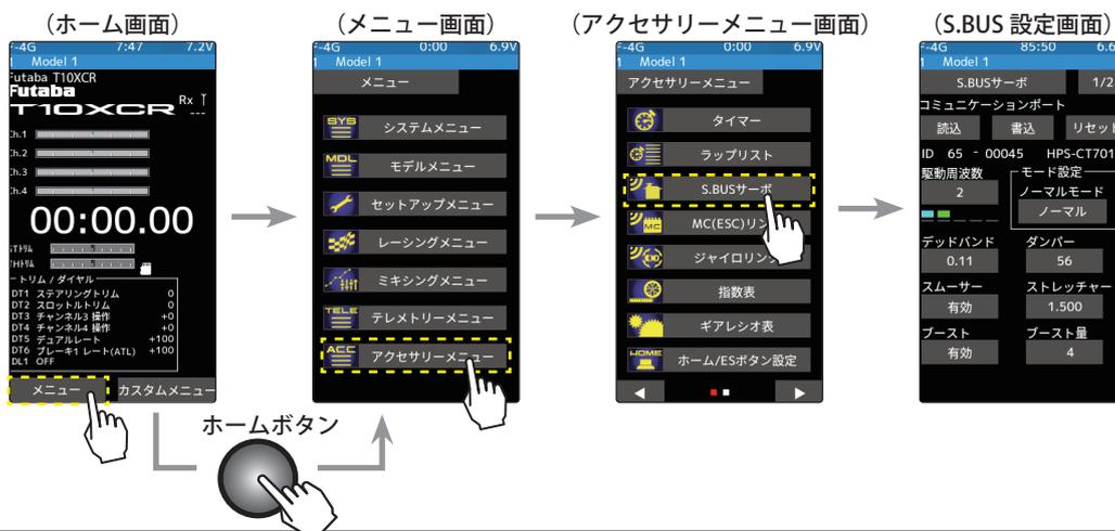
**3** 下記の通り接続した UR サーボのデータを T10XCR に読み込みます。
