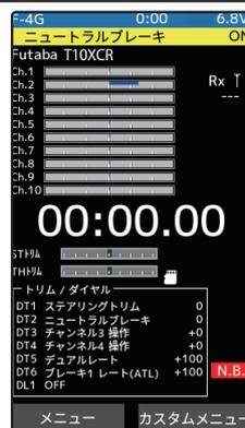
ホーム画面の状態でもニュートラルブレーキスイッチを操作すると、画面上部にポップアップでニュートラルブレーキの ON/OFF を表示します。
