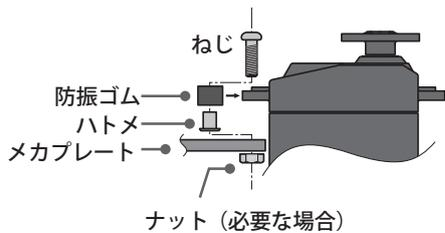
サーボの取り付けには、必ずサーボに付属の防振ゴムとハトメを正しく装着する。(ハトメの向きに注意)
