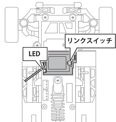
**2** T10XCR 受信機設定画面の【リンク】をタッチします。T10XCR がリンクモードに入り、メッセージが表示されます。
