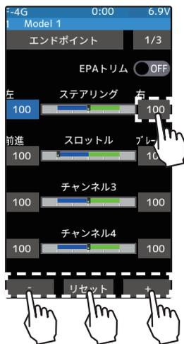
例：エンドポイント画面でステアリングの右側動作量を変更する場合、ステアリングの右をタッチして、画面下に [-][リセット][+] が表示したら、動作量を増やす場合は [+], 減らす場合は [-] をタッチして数値を変更します。タッチしたままにすると連続して数値が変化します。[リセット] をタッチすると、初期値に戻ります。
