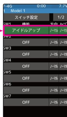
設定画面で割り当てた機能操作を行なうと、操作した SW が緑色で表示されます。ファンクション設定時にスイッチの位置をスムーズに確認できます。
