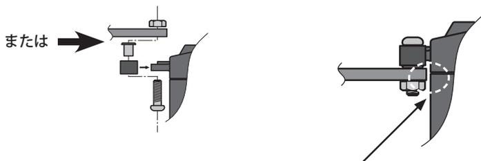
サーボケースと取り付けプレートは接触させない。接触していると正しく防振ゴムとハトメを装着しても、防振効果が得られません。
