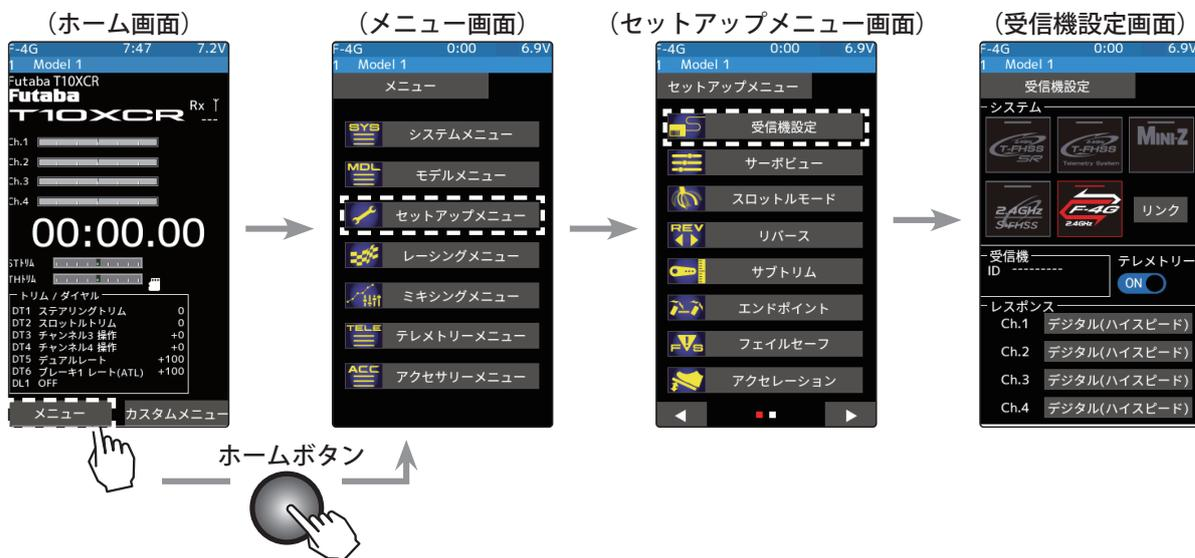
**2** 受信機設定で F-4G / T-FHSS SR / T-FHSS / S-FHSS / Mini-Z の中から、設定するシステム F-4G を選びタッチします。確認画面を表示しますので実行する場合は [はい] をタッチすると、ピピッという電子音がして設定が終了します。キャンセルする場合は [いいえ] を選びタッチします。システムを変更した場合は、必ず受信機とリンクさせ、電源を入れなおします。
