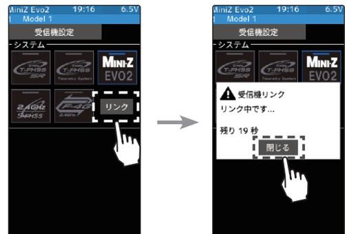
**3** Mini-Z 受信機のリンクスイッチを 2 秒以上押した後、離し、LED が 2 秒点灯ののち、再度点滅したら、T10XCR のリンクモードを解除し、通常モードにしてください。
