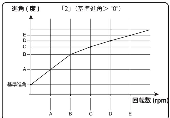
ESC で進角設定機能が禁止されているレースに使用する場合は、**進角設定**を無効にしてください。**進角設定**は、ターボモードの設定より優先されます。ターボモードが[ターボ 1]や[ターボ 2]に設定されていても**進角設定**を[無効]に設定すれば進角設定機能が OFF にできます。MC940,960CR は、進角設定機能が無効 ("0" タイミング) に設定されている場合、LED が点滅表示します。
